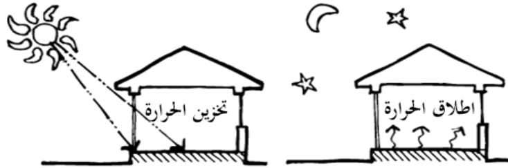
شكل (21-3) امتصاص الكتلة الحرارية للحرارة في النهار و إطلاقها في الليل في الشتاء
