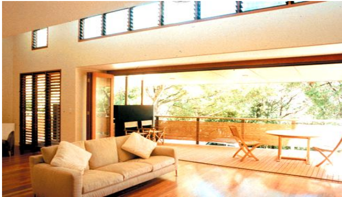
شكل (3-5) وجود شرفة عميقة توفر ظل داخلي و تسمح بدخول الضوء الطبيعي
