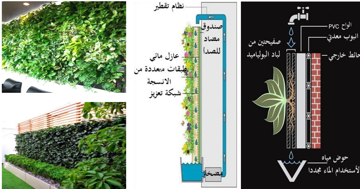
شكل (31-3) تفاصيل الحائط الأخضر الحي , و صور لحوائط خضراء
