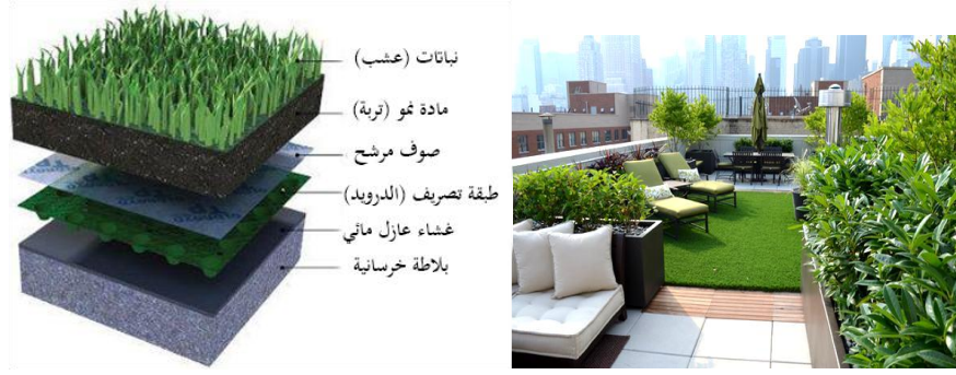
شكل (29-3) بعض التصاميم لحديقة السقف و تفصيل لطبقاتها
