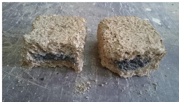
صورة رقم (14) هشاشة ناتجة عن زيادة نسبة النشارة
