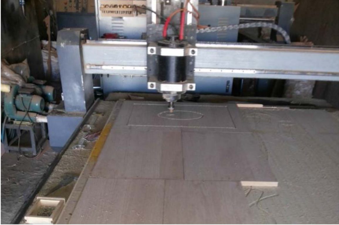
الصورة(7) رقم آلة الحفر الاوتوماتيكية (CNC) (الخالدي وآخرون، 2012 ،ص75 )
