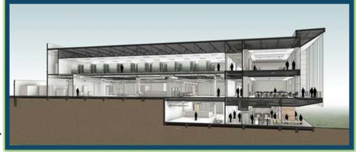
القطاع في مبنى المعلومات حيث استخدم في سطح المبنى علایا شمسية مثبتة على Steel structure
