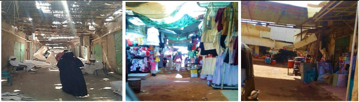
صورة رقم ( 3-23 ) توضح استخدام الزنك و الاقمشة و الحصير لسقف الممرات
