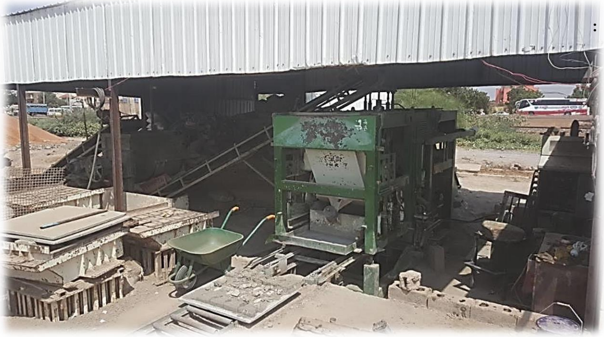
الشكل رقم (4) يوضح الآلات التي يتم عبرها صناعة البلوكات الاسمنتية
