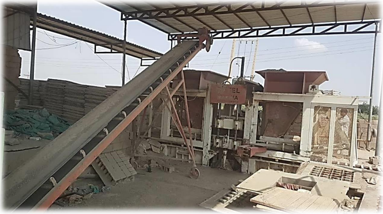
الشكل رقم (6) يوضح الآلات التي يتم عبرها صناعة البلوكات الاسمنتية
