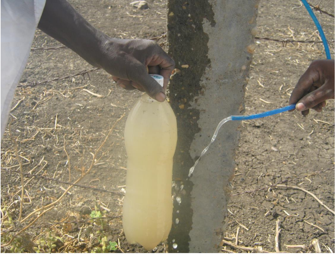
صورة توضح عمل التصميم في ترشيح مياه الحفير والفرق بين المياه المرشحة النازل من الأنبوب البلاستيكي ومياه الحفير الغير المرشح في القارورة .
