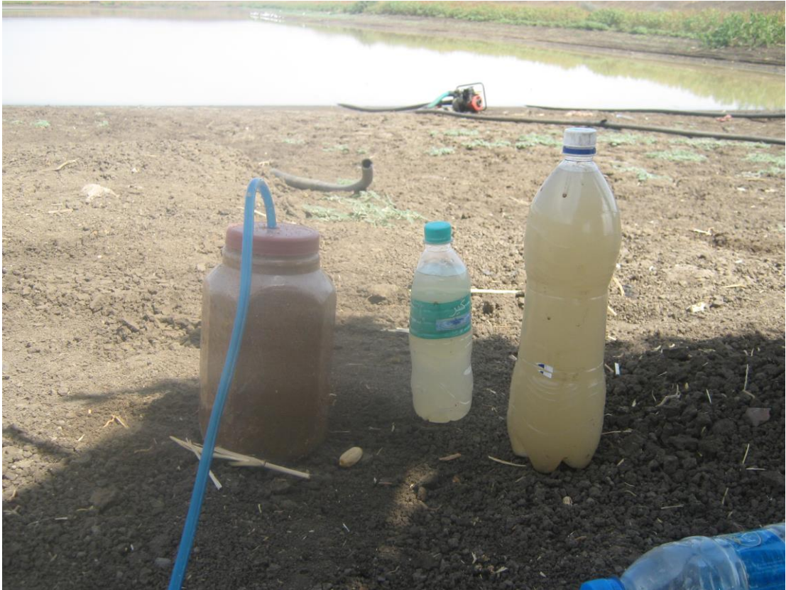
صورة توضح التصميم الذي تمت تجريبه قرب الحفير وبجانبه قارورة كبيرة بها مياه الحفير غير مرشحة ، وأخرى صغيرة بها مياه الحفير بعد الترشيح (تجربة أولى) .
