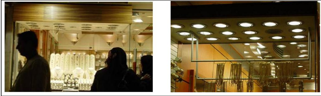
شكل (3- 6) نموذج ناشر محبب أوبال Opal diffuser للتخفيف من وهج المصابيح الكهربائية
