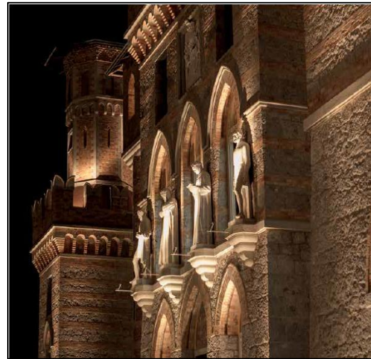
شكل (3-40) طريقة إضاءة المنشآت الأثرية (إضاءة الغمر) (Thorn Lighting , Architectural illumination , No: 547 )
