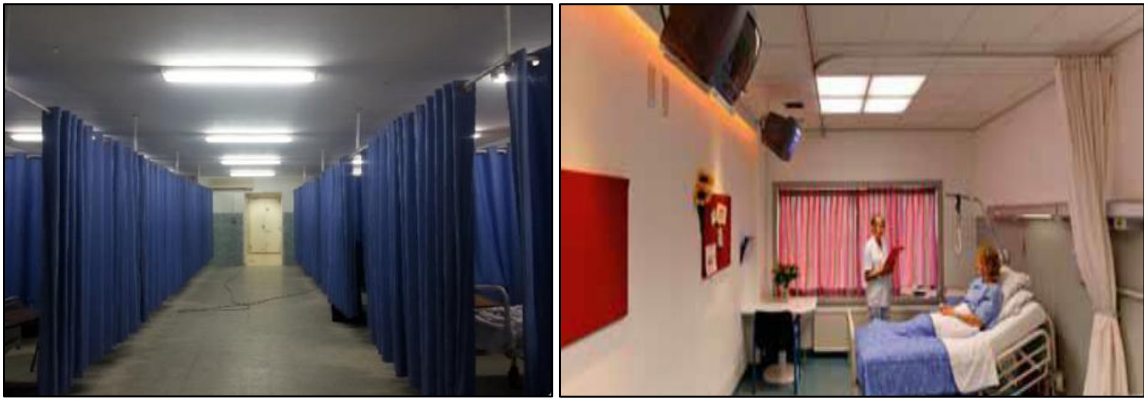
شكل (3-33) استخدام أضواء عامة بالإضافة الى أضواء موضعية في الصورة الاولى غرف العناية، واستخدام مصابيح فلورسنت في أضواء الممرات الصورة الثانية (حبيب،2015)
