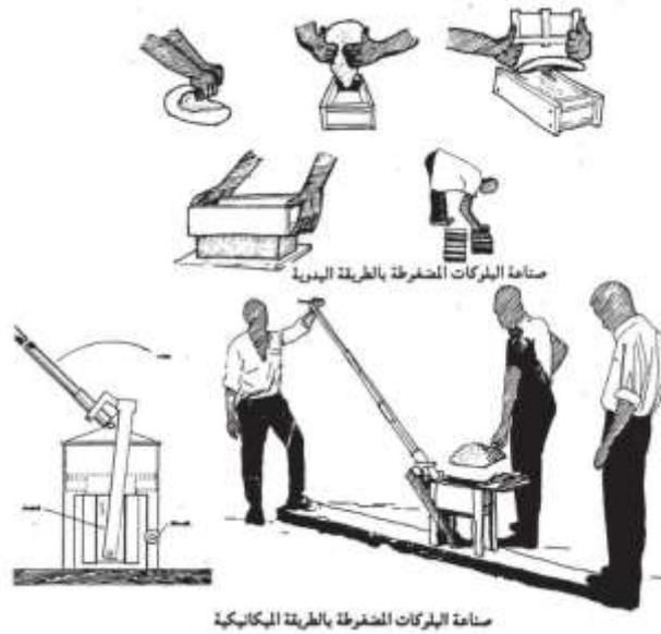
شكل (6-1): صناعة البلوكات المضغوطة.<sup>(1)</sup>
