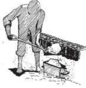
شكل (3-6): صناعة بلوكات الخرسانة يدوياً. (1)
