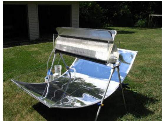
الشكل 3 : جهاز من الالومونيوم للتقطير الشمسي
