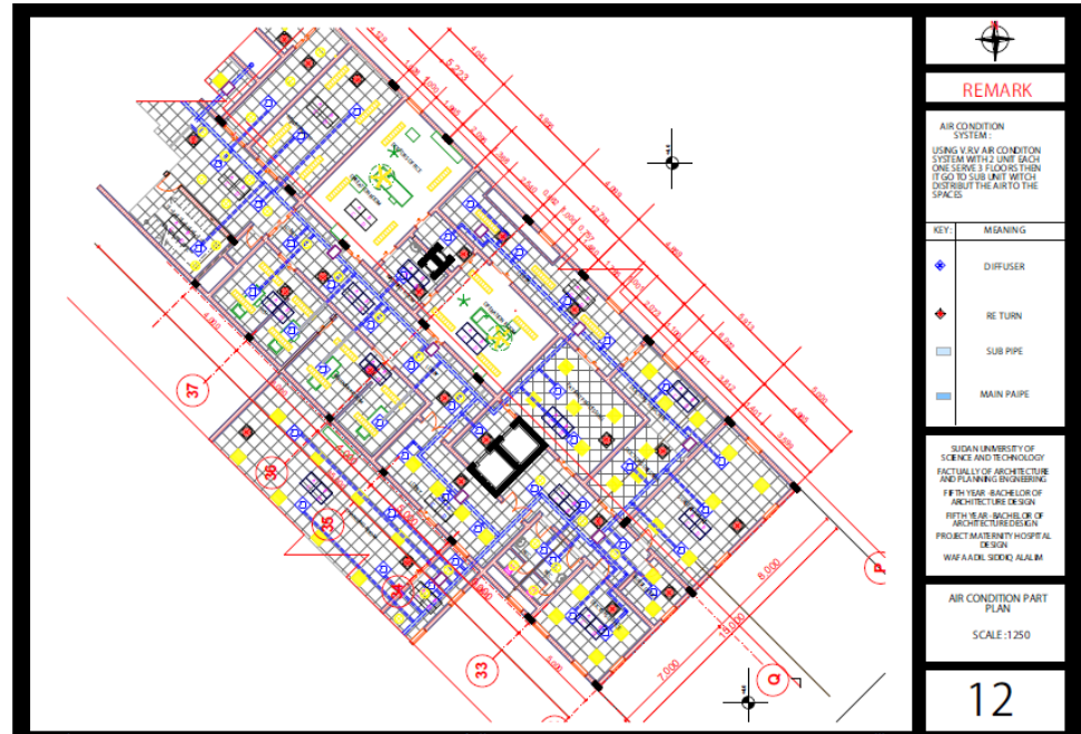
صورة 110 توضح نظام التكيف في المبنى
