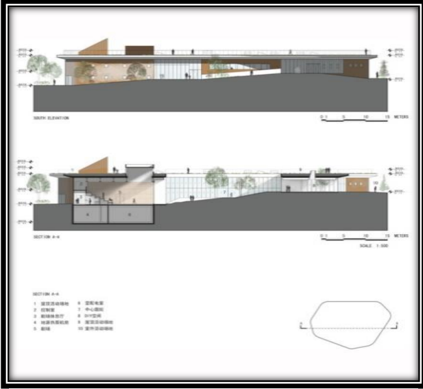
صورة (2-12) توضح مقطع رأسي للمبنى
