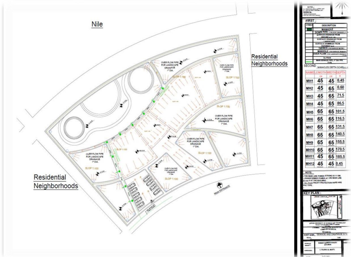
صورة رقم (151) توضح الصرف الصحي و السطحي بالموقع
