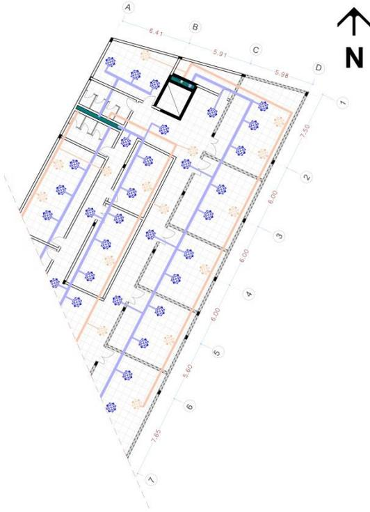
المنظومة المستخدمة في تبريد الماء هي التكييف المركزي (VRV) (غاز - الي - هواء) وذلك لقلّة تكلفته مقارنة بباقي المنظومات حيث يتم نقل الهواء عبر مواسير عبر ال ducts من الوحدة الرئيسية من السقف الي ال indoor units ثم يوزع منها الي ال cassette التي بدورها تعمل على ضخ الهواء للفراغات المختلفة
