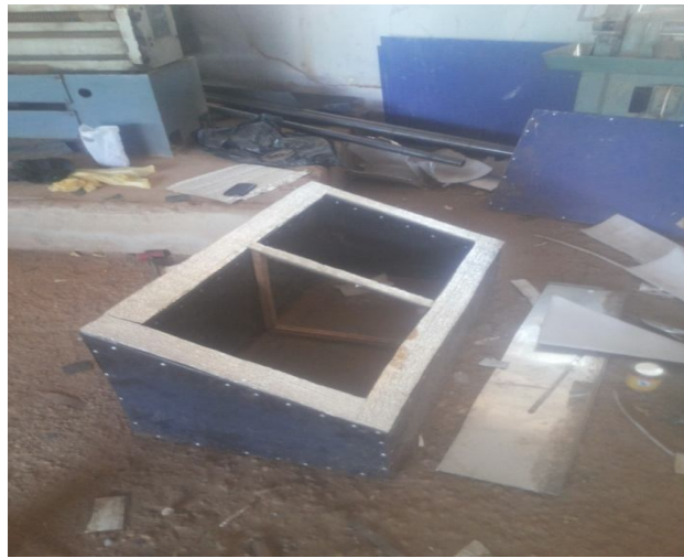
صورة رقم (3-7) : توضح تثبيت العازل العلوي لحماية الزجاج
