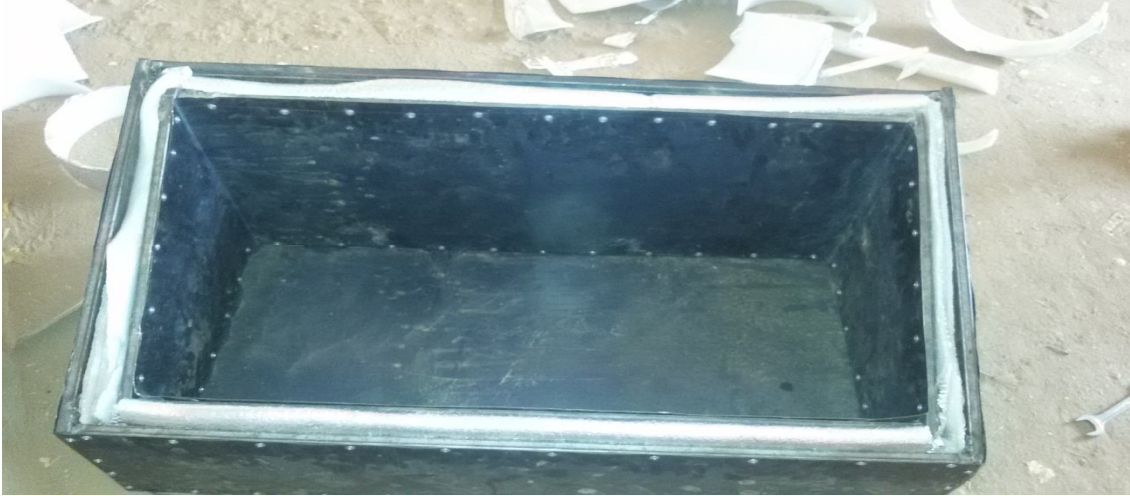
صورة رقم ( 3-4 ) : يوضح وضع العازل الحراري بين الصندوقين
