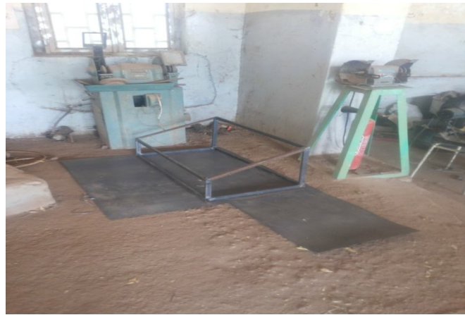
صورة رقم ( 3-1 ) : يوضح الهيكل الخارجي للفرن
