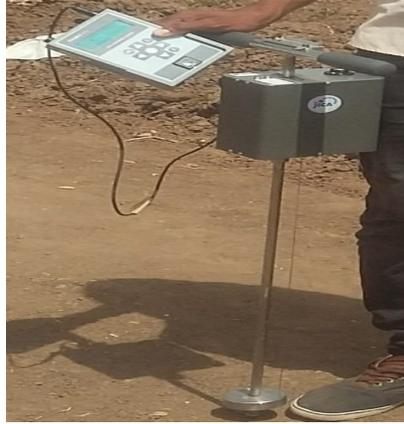
تم استخدام جهاز Vane flow meter لقياس التصريف ( كمية الماء معبر عنها بوحدات الحجملتر/ثانية)حيث يعمل الجهاز بواسطة الريشة المثبتة على الهيكل اضافة الى الاسطوانة العلوية التي يوضع فيها الجهاز الذي يزود بميزان مستوي لضبط الجهاز على المستوى الافقي ويتم قراءة كل من  $y$  التي تمثل المسافة التي تحركتها الريشه اضافة الى قراءة  $W$  وهي تمثل الوزن الذي وضع لارجاع الريشة لموضعها الاول شكل (3-2)
