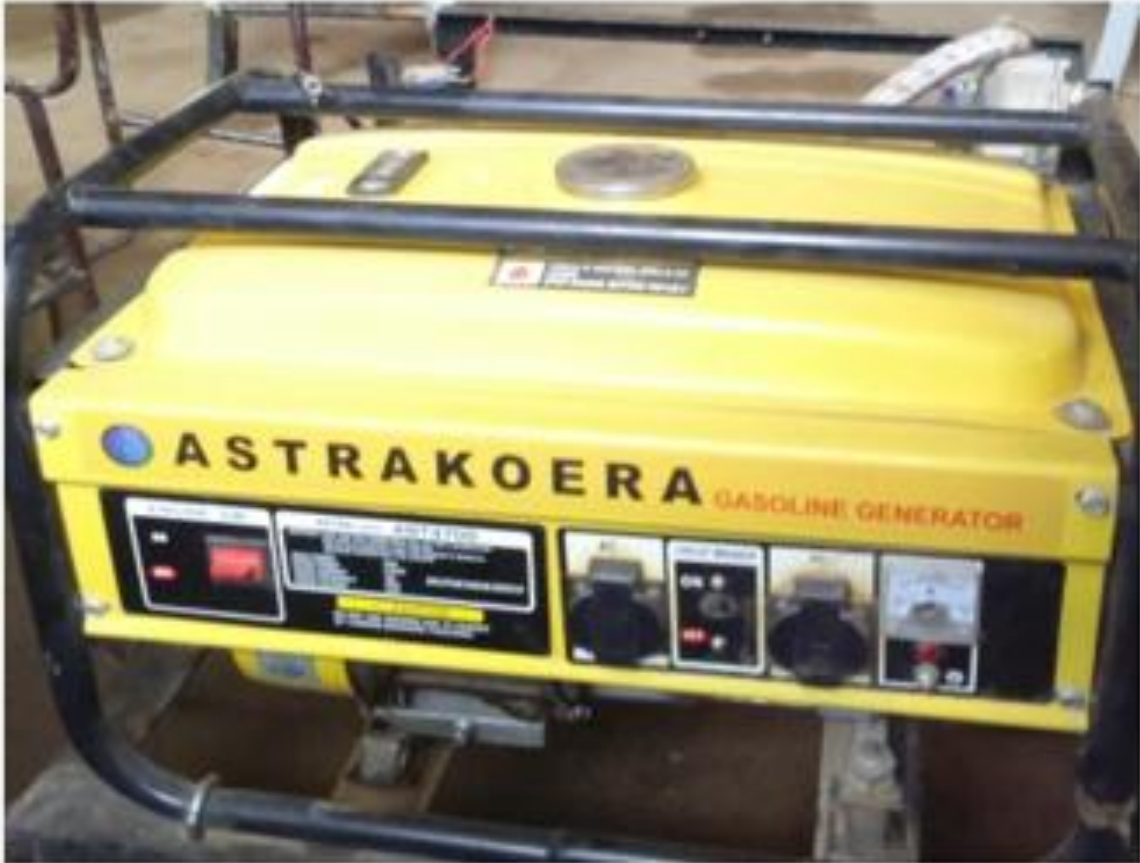
شكل (3-3) يوضح المولد الكهربائي
