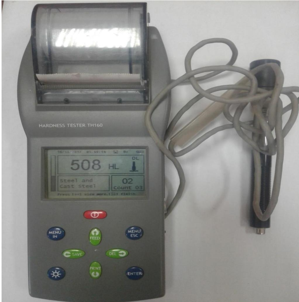
الشكل (2.3) يوضح جهاز قياس الصلادة (Hardness Tester TH160)
