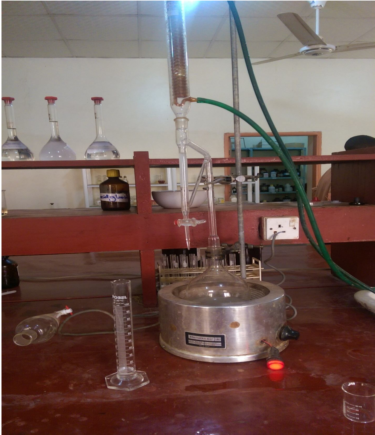
الصورة توضح جهاز إستخلاص الزيت (التقطير المائي)
