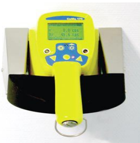
Figure 2.6 shows the contamination monitor CoMo 170
