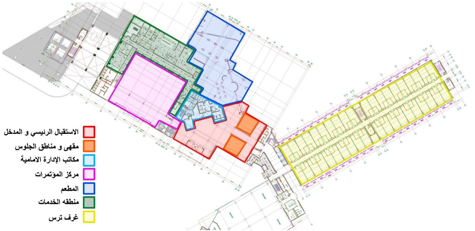
الشكل رقم (4-9) تنطبق المسقط الافقي للطابق الأرضي يوضح الفراغات المحيطة بالبهو (المصدر : الباحث)
