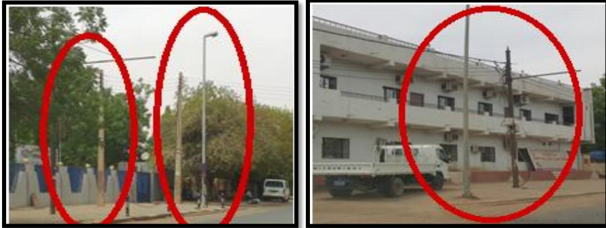
شكل (4-80) صور توضح التداخل بين اعمدة الكهرباء والانارة.
