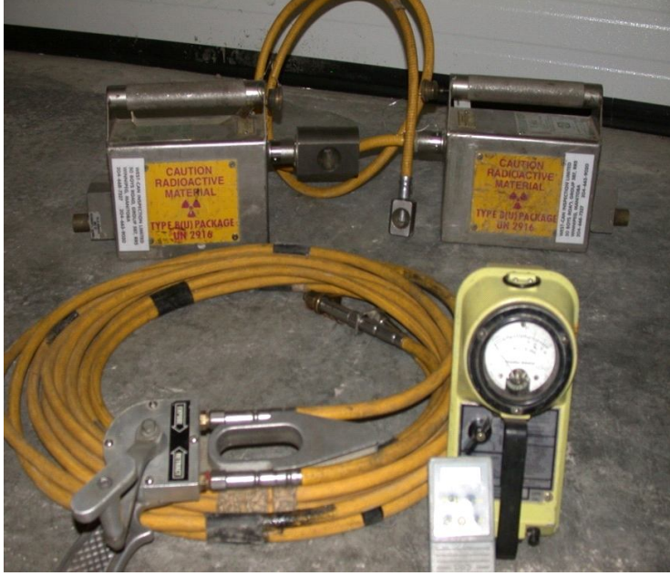
الشكل (2.4) يوضح المعدات المستخدمة للكشف الغير اتلافي عن طريق التصوير الاشعاعي
