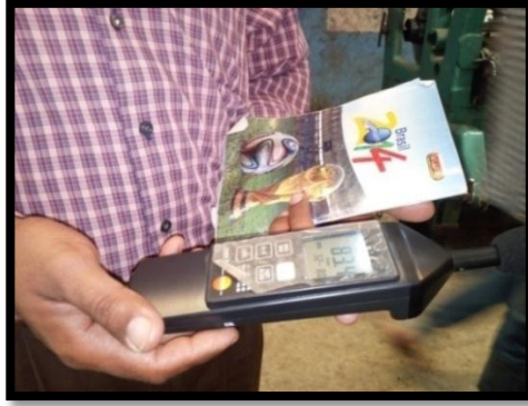
صورة (4-1) جهاز تيسـتو 815 المستخدم في قياس مستوى الضوضاء
