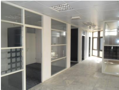
صورة (4-20) إضاءة الاستقبال المؤدي لمساعد الطوابق ويربط بالبوابة الخارجية عامة بوحدات Down lights موزعة بانتظام على سقف ديكوري مستعار مخرم Perforated والألوان الدافئة تغلب على المكان
