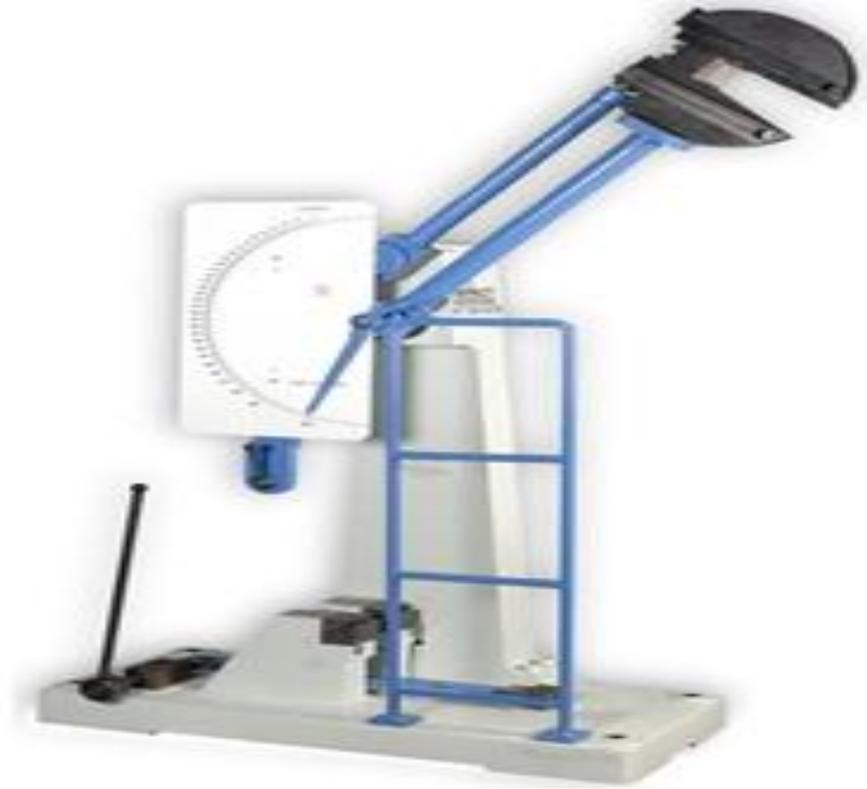
الشكل (3.6) يوضح جهاز اختبار الصدم بطريقة أيزود
