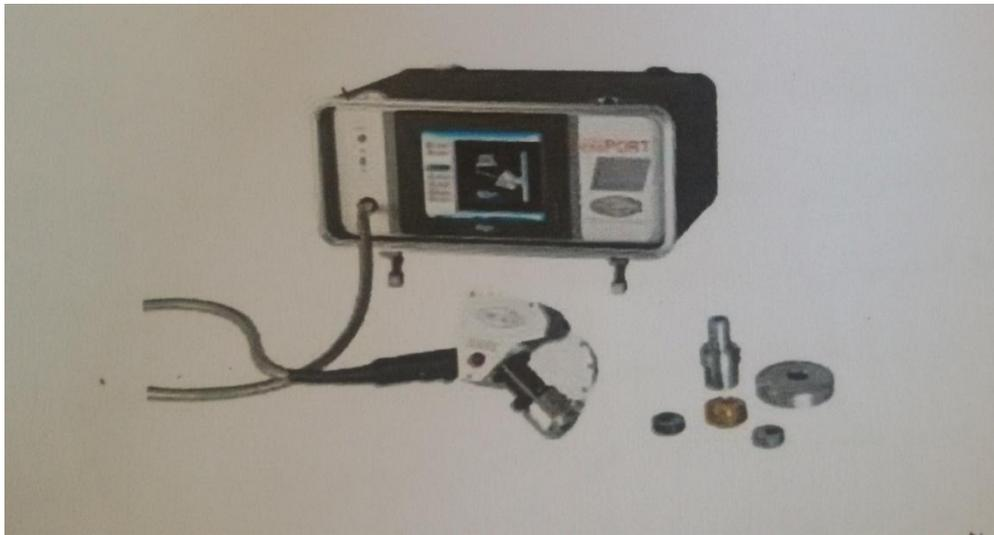
الشكل (3.3) يبين جهاز الفحص الكيميائي لمكونات العينات
