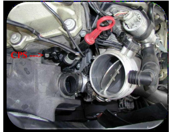
الشكل ( 2 - 7 ) يوضح حساس وضع عمود الكامات
