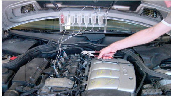
شكل (5-10) توصيل أنابيب تجهيزه الوقود الفائض
