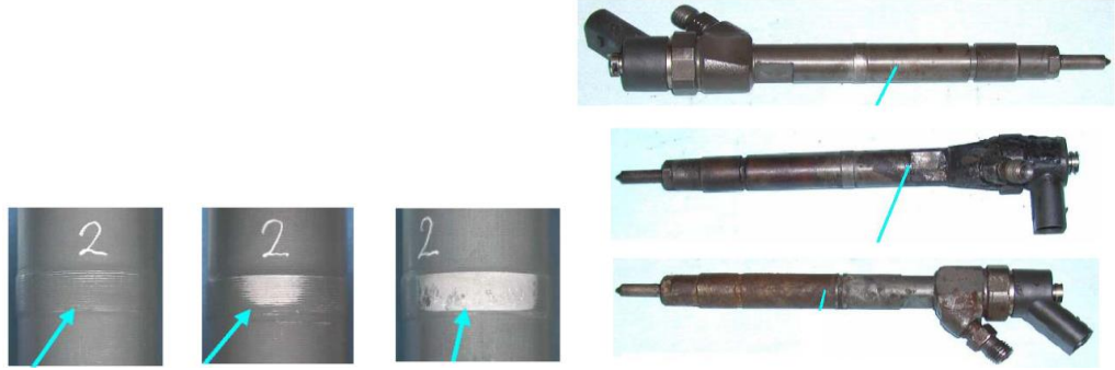
الأشكال (5-15) عيوب أجزاء الرشاش الخارجية
