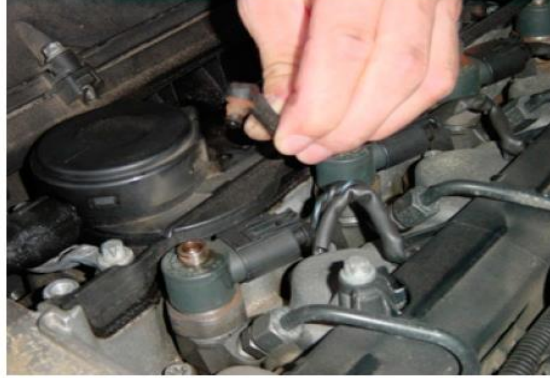
شكل (5-9) فصل أنابيب الوقود الفائض
