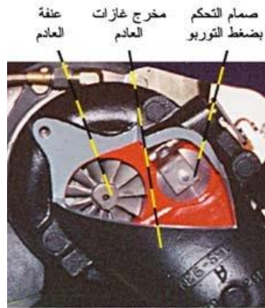
الأشكال (4-17) يوضح أشكال صمام تحكم التيربو
