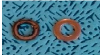
شكل (11-5) حلقات أحكام تثبيت الرشاش
