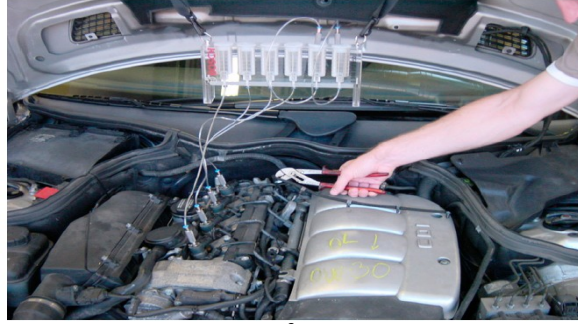
شكل (10-5) توصيل أنابيب تجهيزه الوقود الفائض
