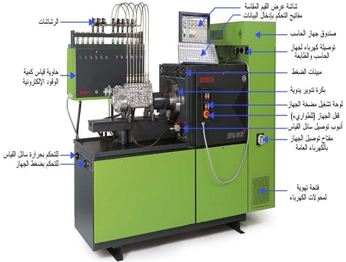
شكل (5-16) جهاز فحص وضبط أنظمة حقن الديزل Bosch EPS 815
