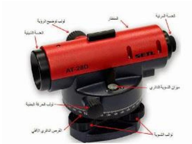
الشكل (3.3) أجزاء و مكونات جهاز الميزان
