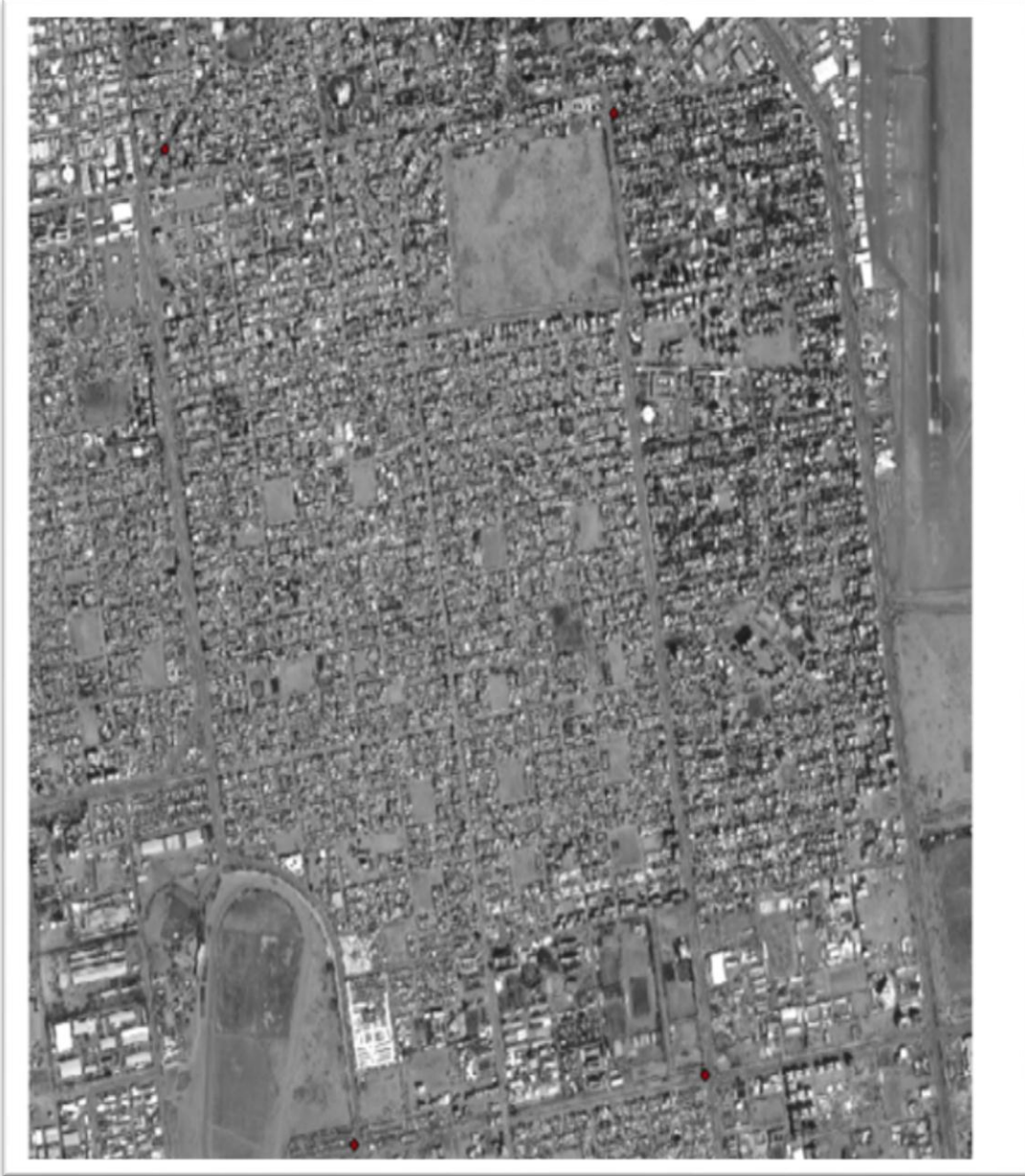
شكل 2-3 صورة الأقمار الإصطناعية التي تم تصحيحها هندسياً وتظهر عليها نقاط الضبط المرصودة
