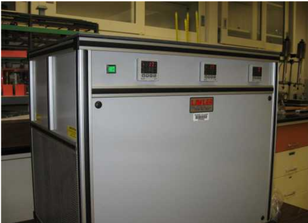
Photograph (3.2) pour point cabinet.
