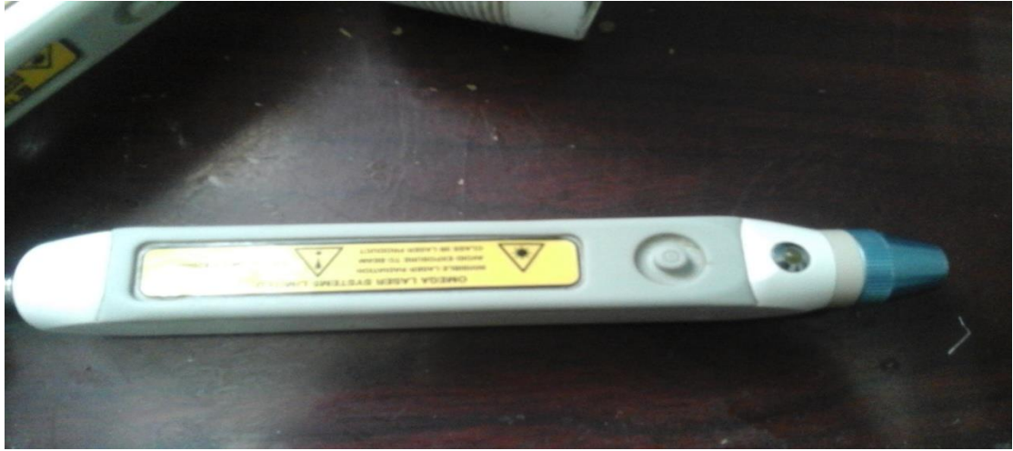
شكل رقم (1.4.4) : يوضح المجس الفردي ذي الطول الموجي 820nm
