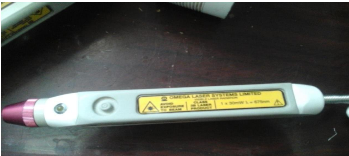
شكل رقم (2.4.4) : يوضح المجس الفردي ذي الطول الموجي 675nm
