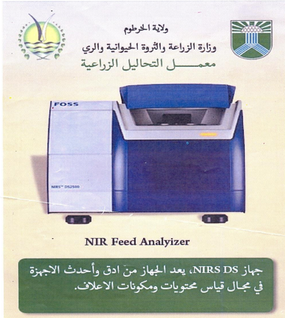
Plate (5): NIR feed analyzer:
