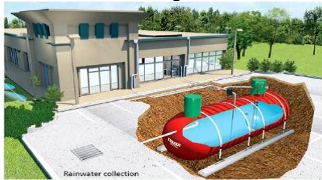
صورة (3-5) نظام تجميع مياه الامطار / South Dover Elementary School
