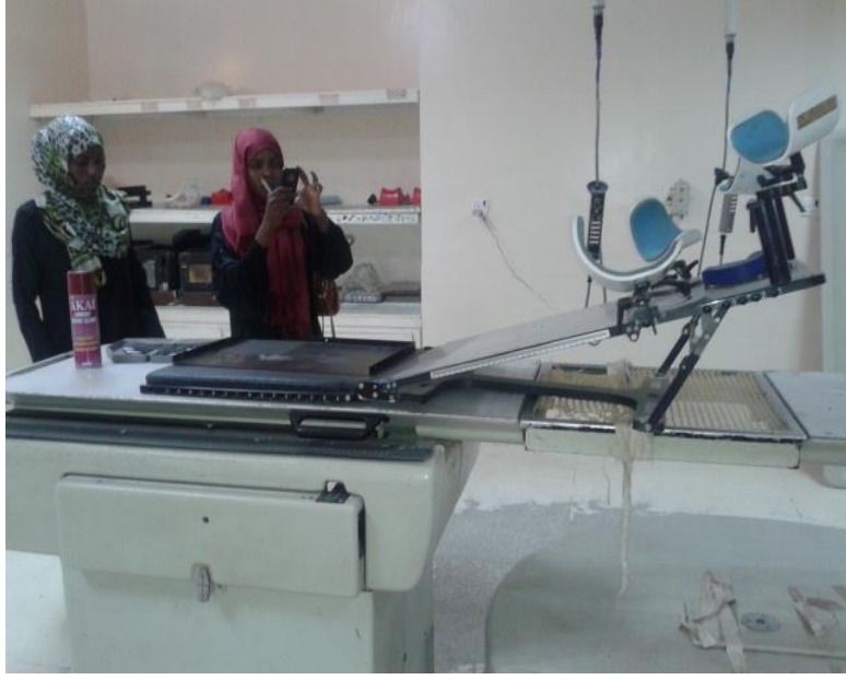
(5-6) صورة توضح سرير المعالجة في جهاز السايترتون
