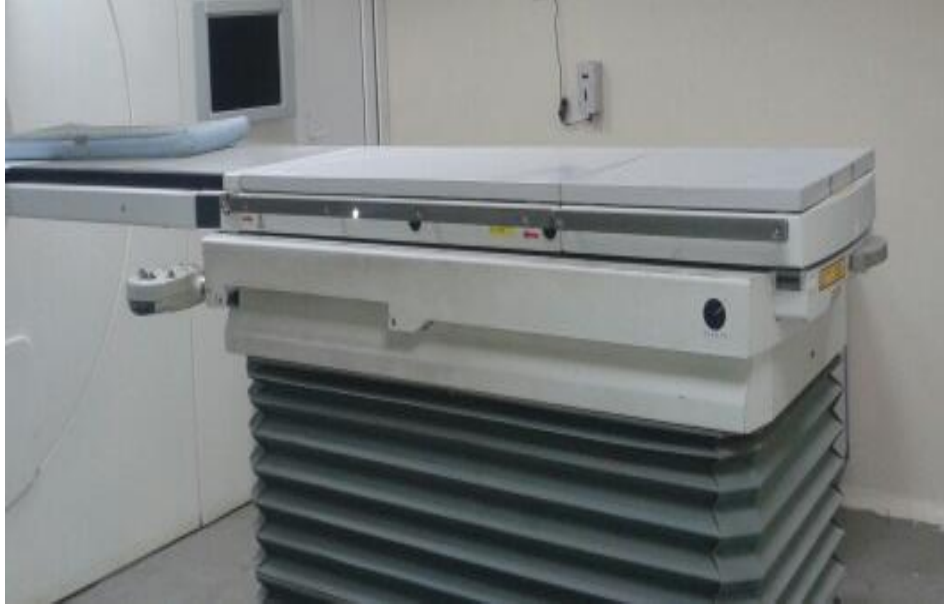
(8-5) صورة توضح سرير المعالجة في جهاز المسرع الخطي
