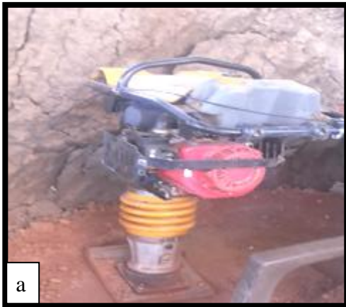
شكل (٨ - ٣) ماكينة الدمك علي الردميه الخرسانيه
