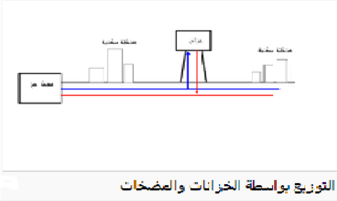
الشكل (2-3): يوضح توزيع المياه بواسطة التخزين والضخ
