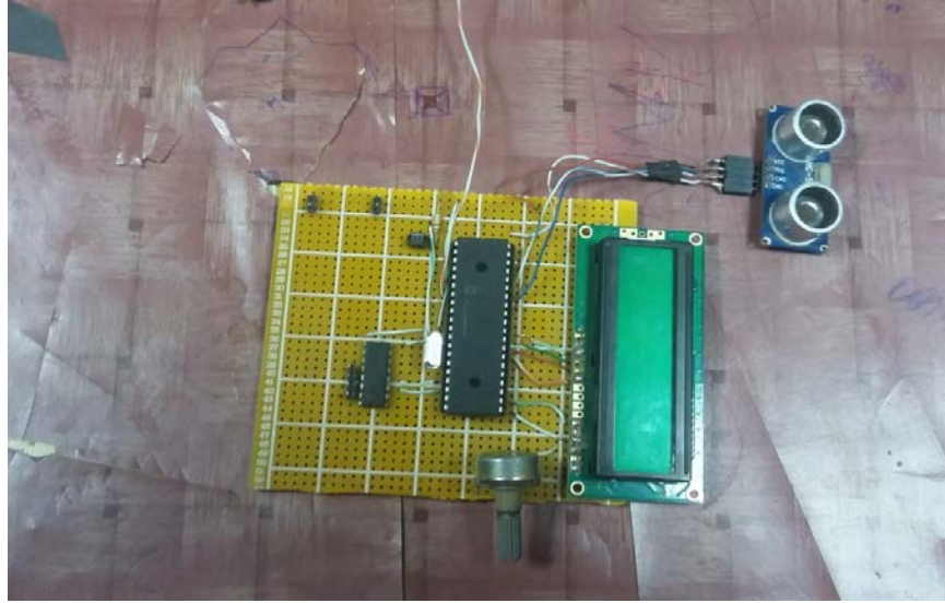
الشكل (2.2.5) يوضح الدائرة المستقلة و جميع مكوناتها
