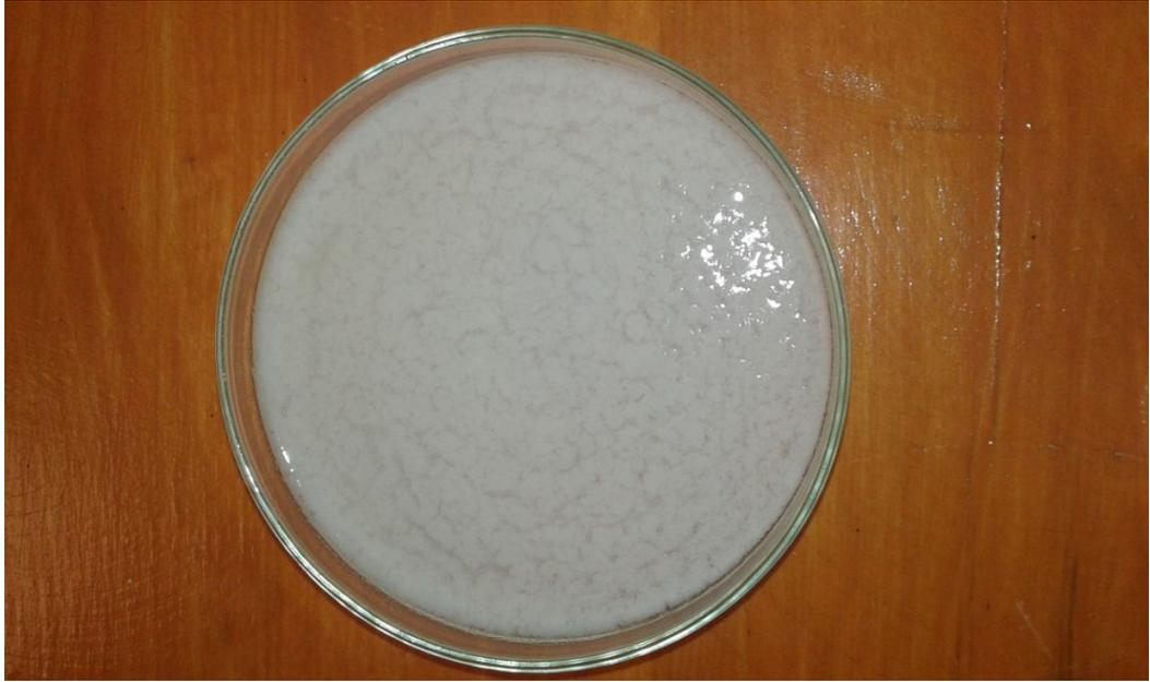
تم اضافة 0.05 من السليكا مع الأيثانول و 4.95 بوليمر مع الاستون ثم تم خلطهما معا وذلك باستخدام جهاز الخلط ثم صببت في better dishes حتى تجف كررت هذه العملية لكل من العينتين ، اخذت هذه العينات وهي جافة وتم قياس معامل الامتصاص لها بجهاز الUV .
