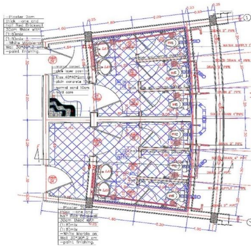
صورة (21-1-5) توضح تفاصيل مواسير الصرف بالحمامات
