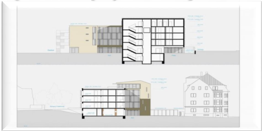
صورة رقم (15): المقاطع الرأسية للمبنى
