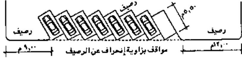
شكل رقم (2-3) الحد الأدنى لبعد المواقف المائلة عن تقاطعات الطرق المصدر: دليل أنظمة واشتراطات البناء، أمانة محافظة جدة
