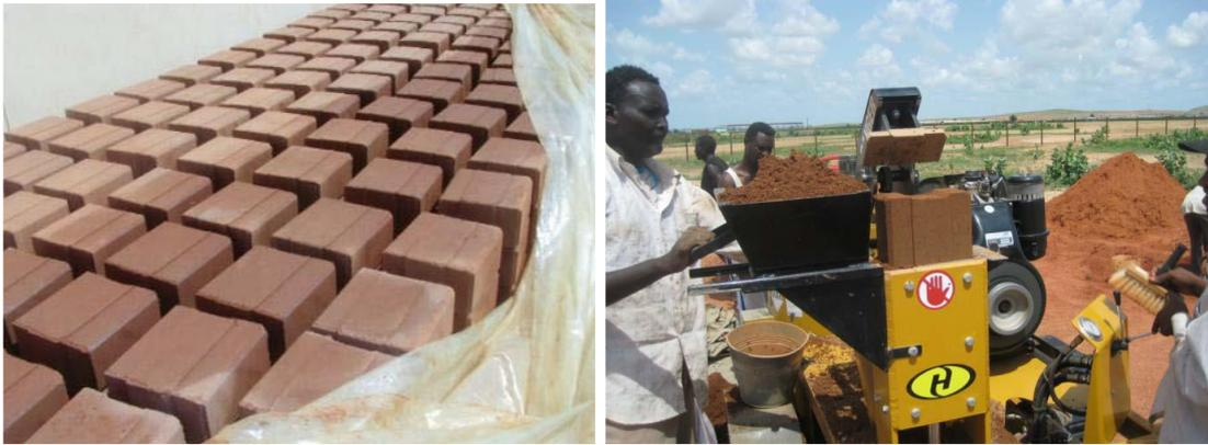
شكل رقم ( 3-13 ) ضغط وتثبيت التربة
