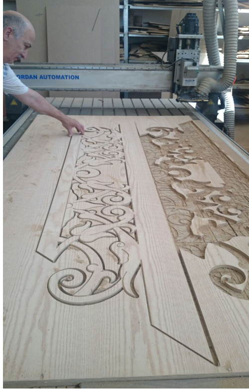
الصورة رقم (229) تبين قطع التصميم الزخرفي اثناء تنفيذ العمل على ماكينة (CNC)
