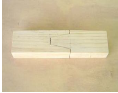
الصورة رقم (185) تين طريقة وصلة البناء
