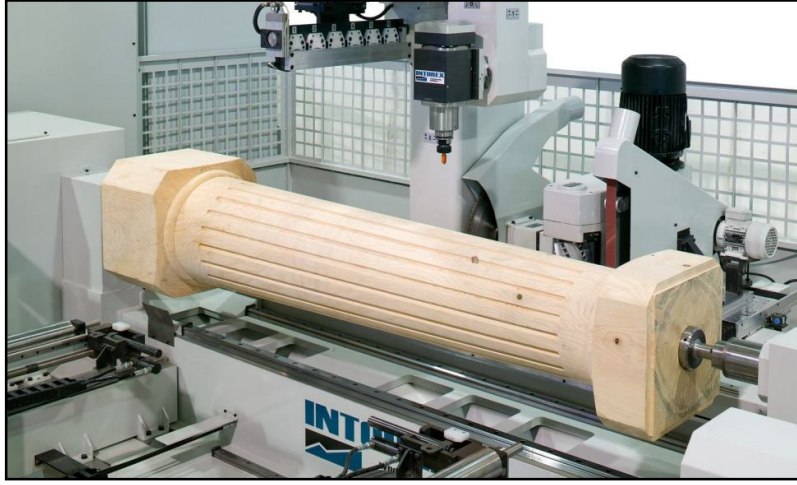
الصورة رقم (171) تبين مخرطة اتوماتيكية وتقوم هذه الماكينة بخراطة الاشكال الحلزونية وعمل الافاريز بشكل طولي
