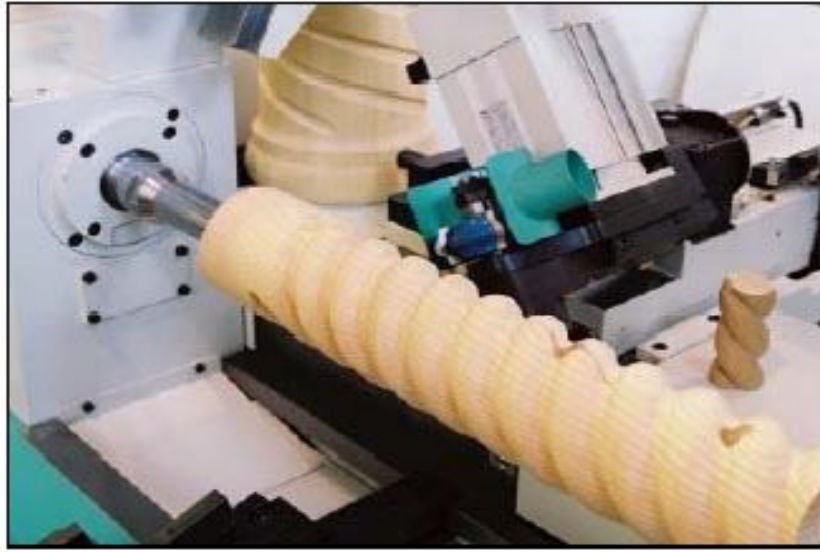
الصورة رقم (172) الخراطة الحلزونية
