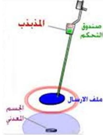
الشكل (2-4) يوضح اجزاء جهاز تقنية النبضات التذبذبية
