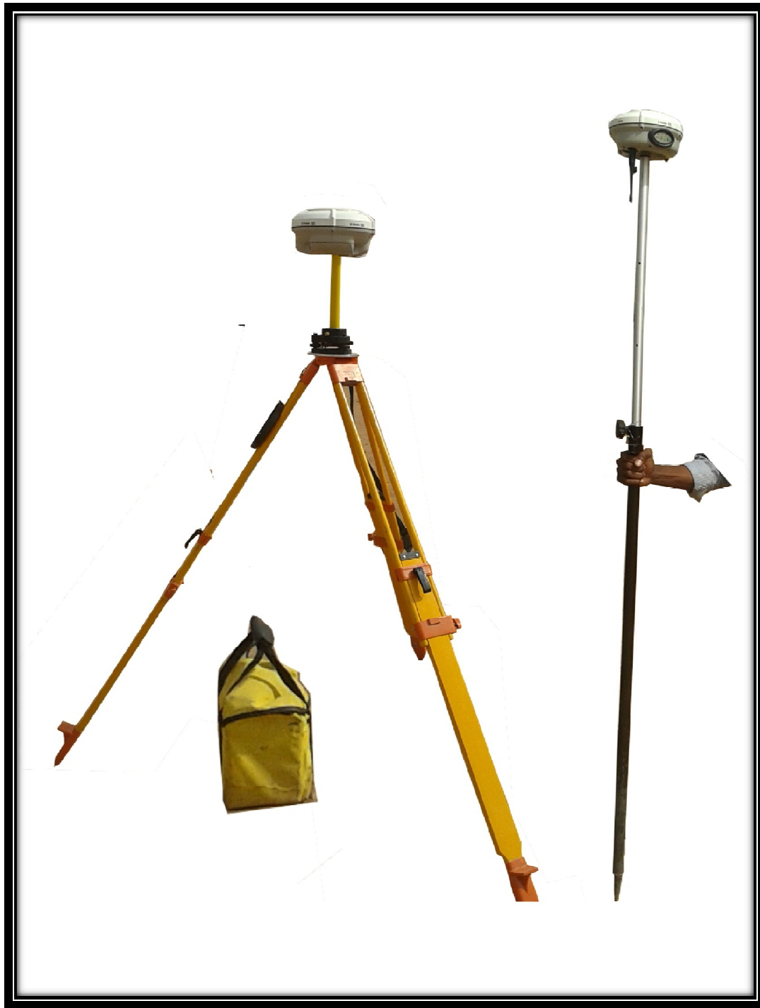
شكل (5-6) جهاز Trimble لأعمال المساحة .
