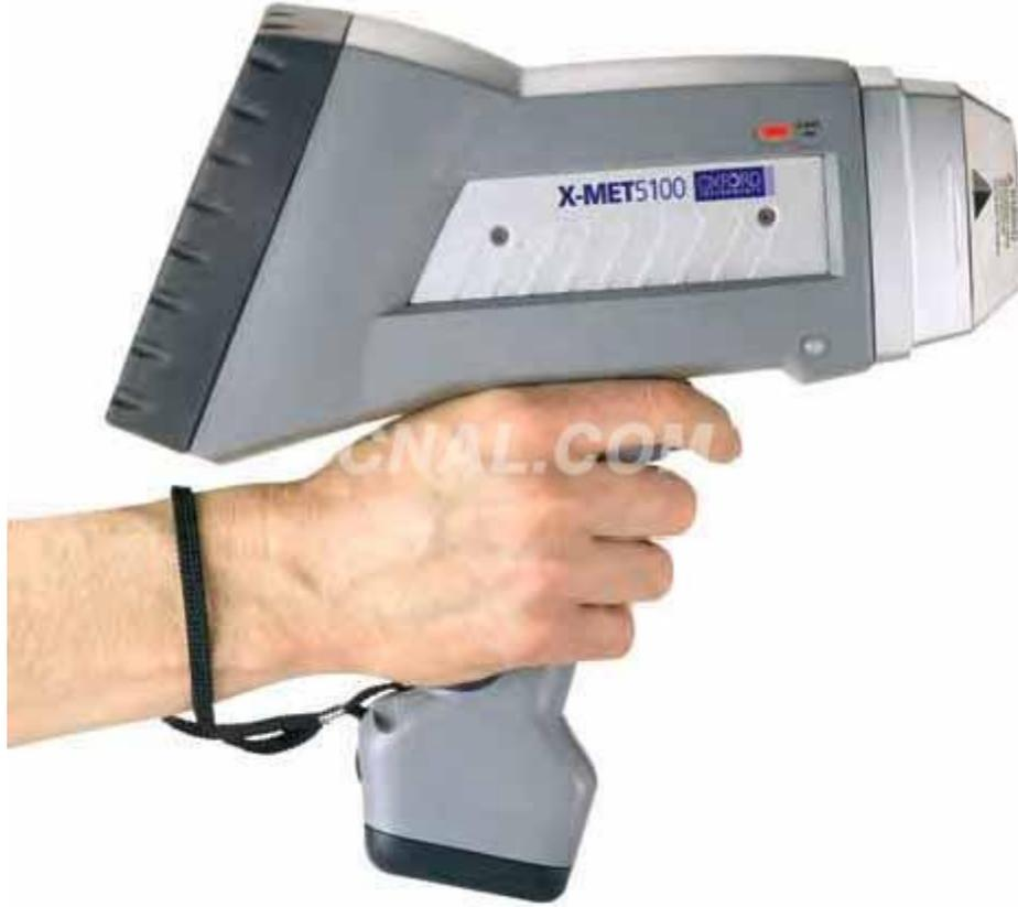
الشكل (1.4) جهاز تقنية الاشعة السينية المتفلورة
