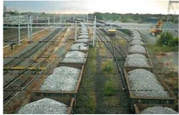
الشكل (5) عربات شحن مكشوفة لنقل الفحم الحجري
