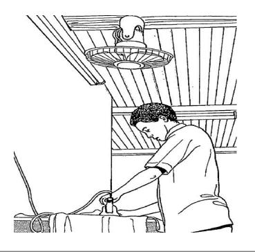
توفير التبريد المباشر للعمال الكي وذلك بسبب ارتفاع درجة الحرارة الناتج من المكواة
